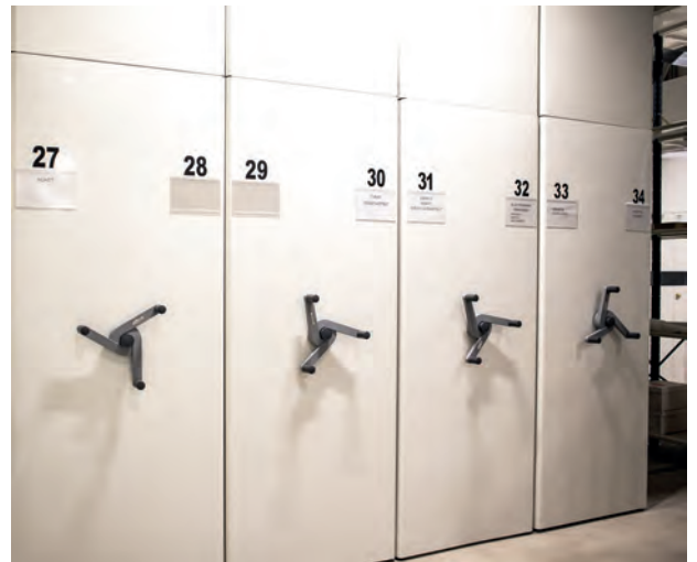
Kasten-siirtohyllly on tilaa säästävää ratkaisua.
