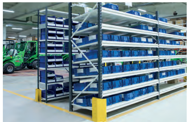
Kaksilaatikkojärjestelmä kevytorsihyllyllä toteutettuna.
