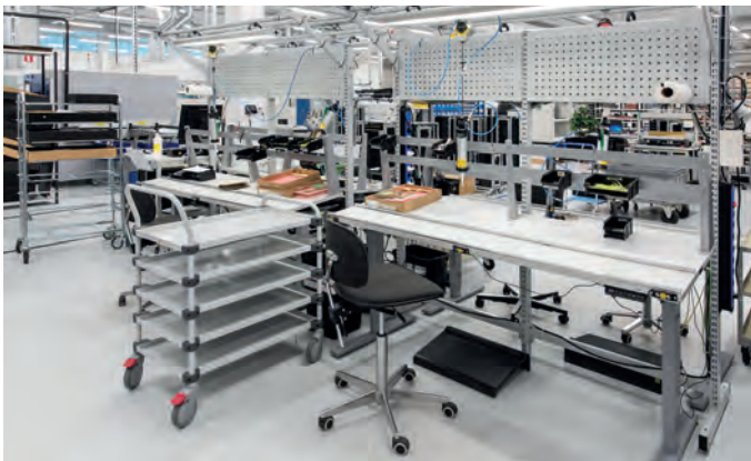
Herkkien sähkökomponenttien käsittelyyn valittiin ESD-kalusteet.
