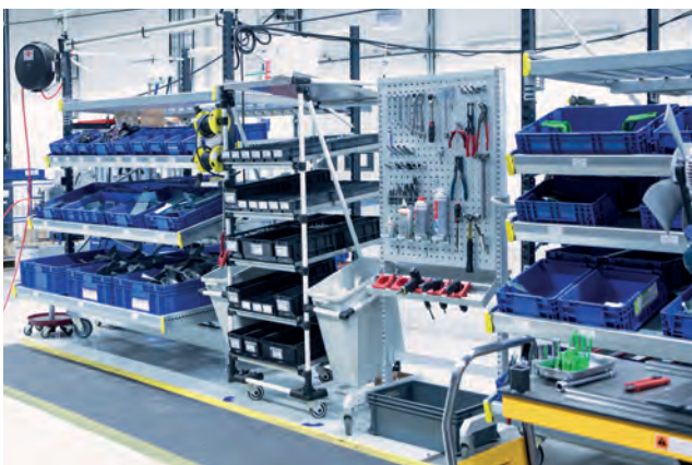
Pyörien päällä olevat hylly- ja reikälevyratkaisut tuovat joustavuutta tuotantoon.
