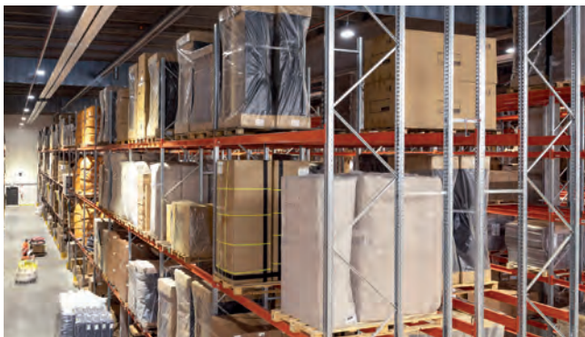
Huonekalulavojen hyllyt toteutettiin ns. 3-pylväselementillä, jolloin hyllyn etuosassa voidaan tarvittaessa varastoida myös standardimittaisia EUR- ja FIN-lavoja.
